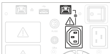
Fig. 38: Prise de connexion des câbles du bain de froid
